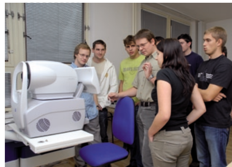
Laboratoř oční optiky – přístroj na snímku kombinuje funkce autorefraktometru, rohovkového topografu a aberometru
